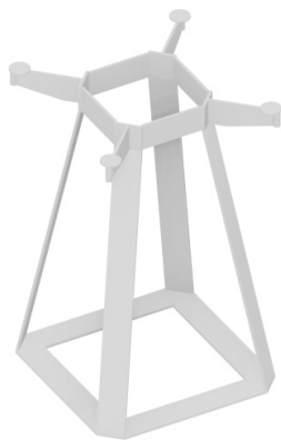
rys. 1- Noga stołu w formie przestrzennej ramy
